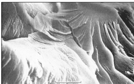
Поверхня сколу вітрени, виділеного з вугілля низької стадії вуглефікації. С., Західний Донбас. Скануючий електронний мікроскоп, x2000. Шкала 10 мкм.
