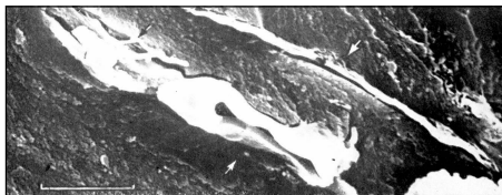
Ліптиніт. Мегаспора (стрілка вгору) та мікроспора (стрілка вниз) на вертикальній поверхні сколу вугілля низької стадії вуглефікації. S_1 . Західний Донбас. Скануючий електронний мікроскоп, \times 2000 . Шкала 10 мкм.
