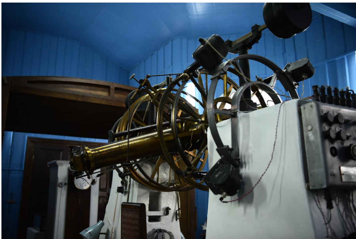
Рис. 4. Меридіанне коло обсерваторії, виготовлене у Гамбурзі (Німеччина) 1872 р.
